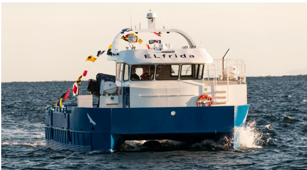
Den hybridelektriske arbeidsbåten Elfrida, ble tatt i bruk av Salmar Farming i 2017, med 80-90 prosent elektrisk drift. Foto: Enova
